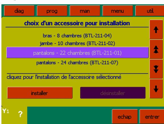
Pour confirmer l'installation d'un nouvel accessoire, appuyez sur le bouton „oui“. Ensuite, sélectionnez le bon accessoire et appuyez sur le bouton d'**installation** ou d'**entrer**. Les données seront stockées dans l'unité de commande et l'appareil rappelle automatiquement l'accessoire approprié.
